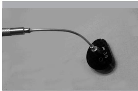
**Figuras 15a y b.** (a) Medidores de anillos (en los extremos) con su correspondiente sostenedor maleable. (b) Imagen ampliada del medidor y su sostenedor maleable.
