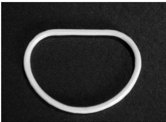
**Figura 1.** Alma o núcleo de goma siliconada desprovisto de su recubrimiento
